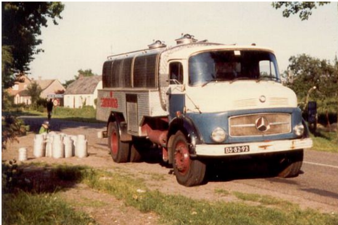
Tussen 1973 en 1981 haalde deze Mercedes L1513 melk op voor de Maasvallei, wat later is opgegaan in Campina. De tank is een Schwarte met een inhoud van ongeveer 10.300 liter. Op deze foto zijn er net melkbussen leeggezogen. Bij de Maasvallei was het ophalen van bussenmelk al per 1973 verleden tijd, bij Campina sinds 1979.
