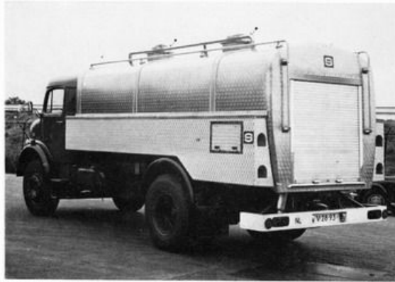
Type „Maasvallei“ Inhoud: 10.500 liter, wielbasis: 4,20 m, chassis: Mercedes Benz Voor bussen en diepkoeltanks.
