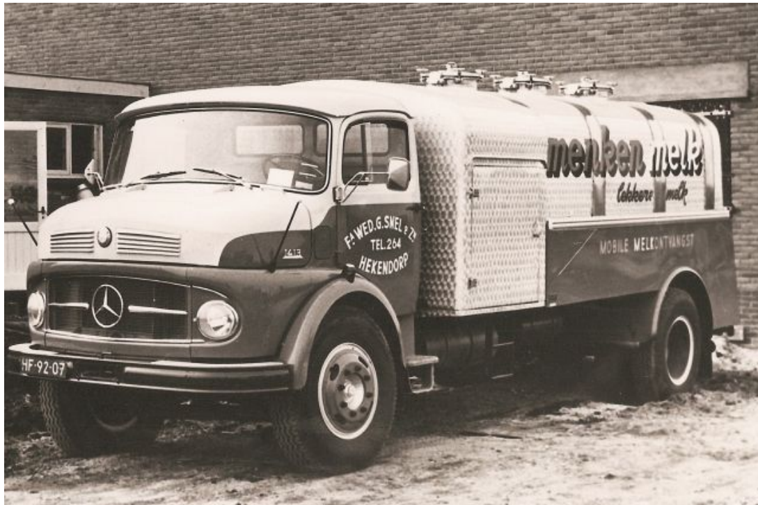
Hier één van de eerste officiële RMO's van Nederland. Deze Mercedes-Benz 1413 uit 1965 is voorzien van een aluminium Jansky-tankopbouw, en eveneens een Jansky pompinstallatie. Er waren toentertijd nog maar weinig veehouders die de melk in een tank leverden, dus reed de RMO niet alleen voor Menken, maar ook bijvoorbeeld CMC (het latere Melkunie) en AMC in Uithoorn. (bedoeld als voorbeeld)
