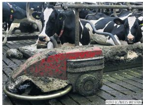
Een robot duwt de drijfmest in de kelder.
