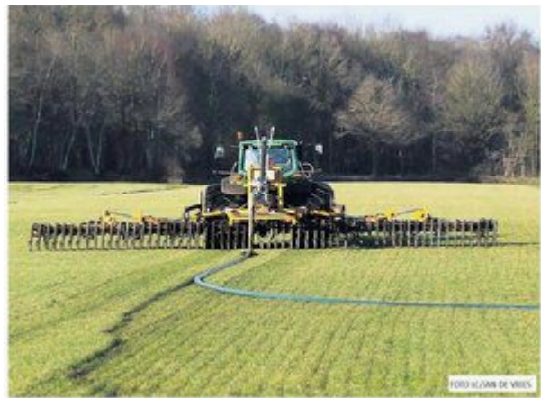
Een mestinjecteur aan het werk bij Makkinga. De mest wordt per sleepslang aangevoerd, waardoor de boer kan doorwerken zonder voortdurend de giertank opnieuw te vullen.
