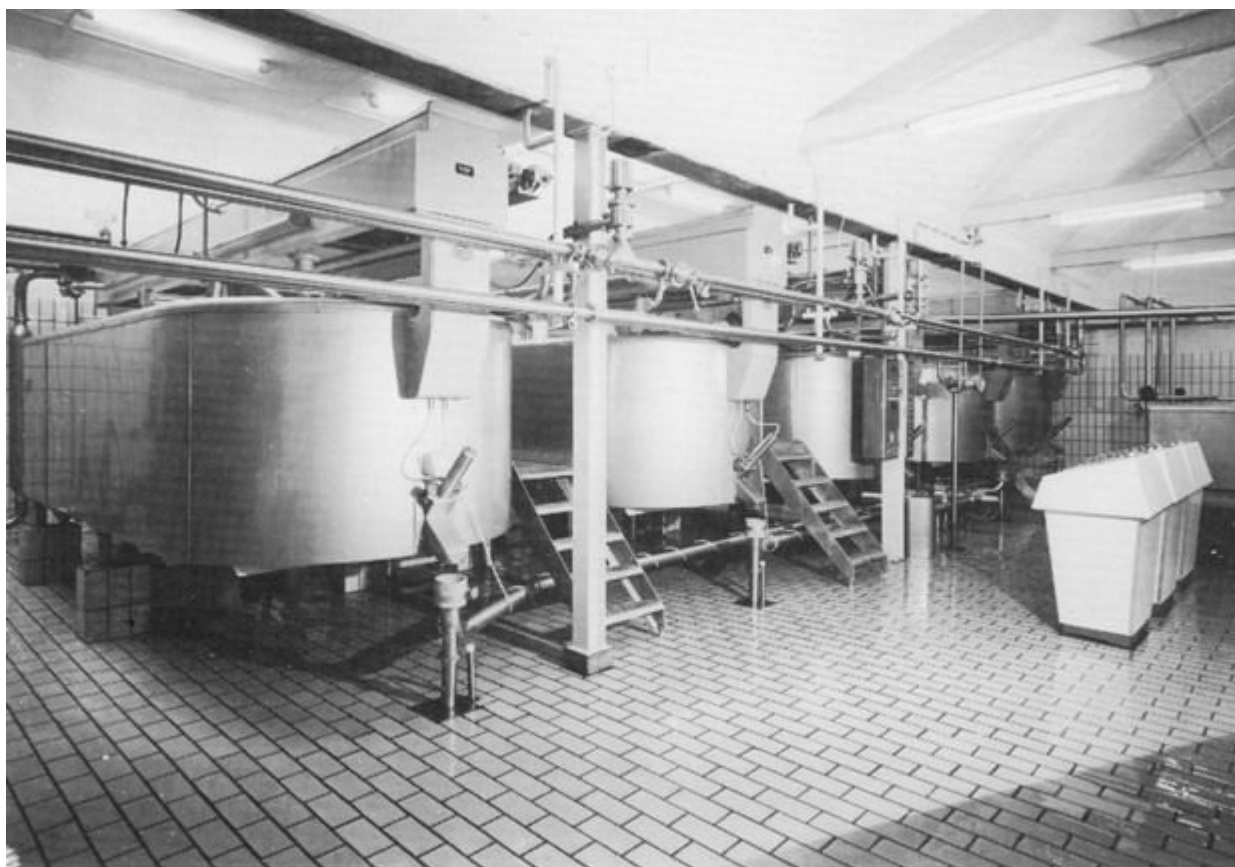
Wrongelbereiders met een capaciteit van 6 X 10.000 L. zoals die van 1972 tot 1986 in Oosterwolde werden gebruikt
