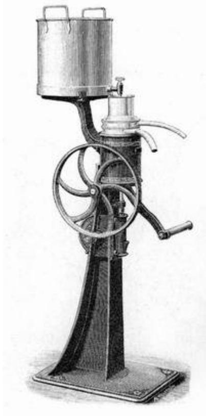
De eerste Alfa Laval, een handgedreven type (1878)
