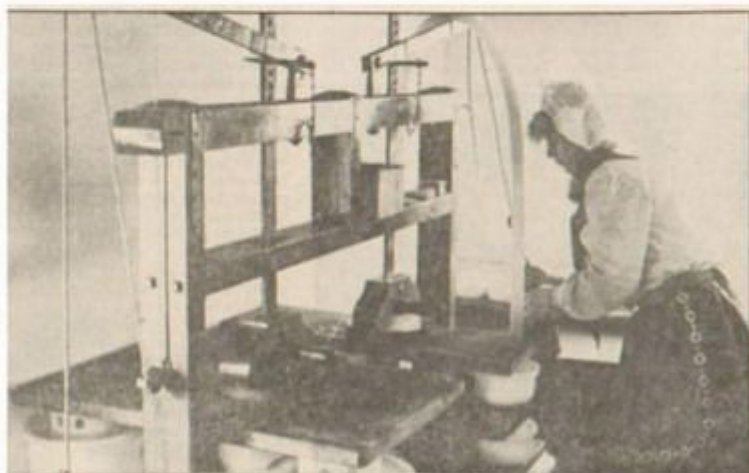
Onder de kaaspers krijgt de boerenkaas de eigenlijke vorm.
