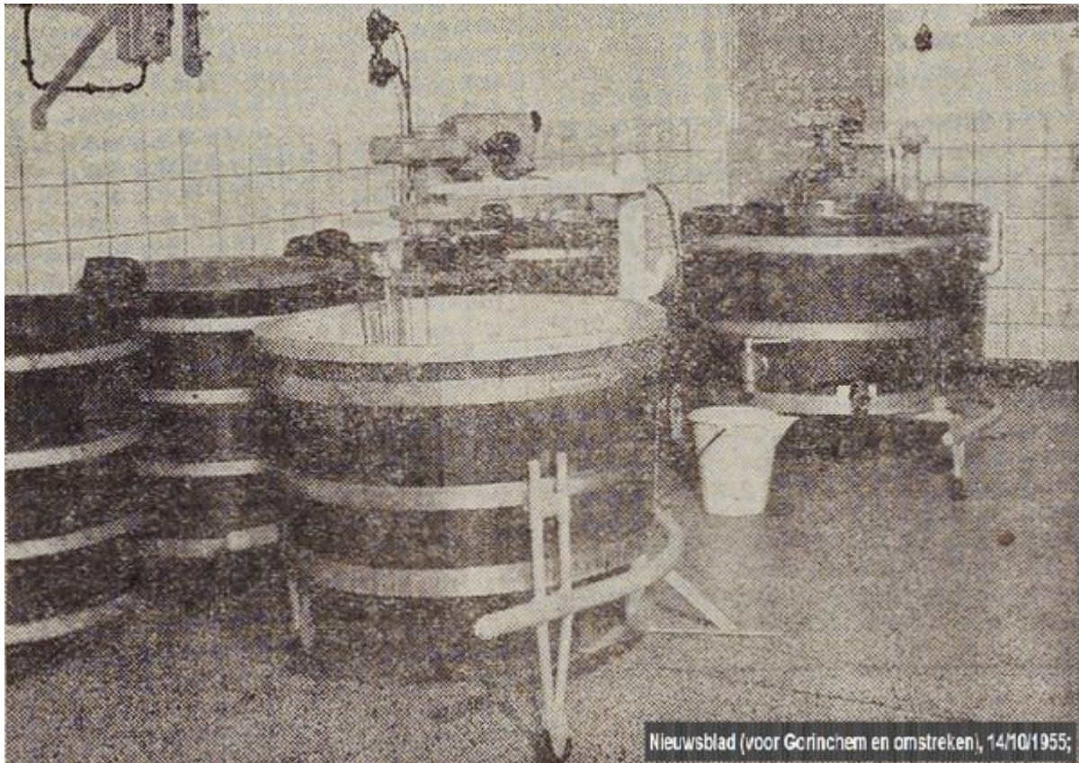
Een kijkje in het uitstekend geoutilleerde wringhuis van "De Calshoeve". U ziet de kaastobben op hun tuimelstoel en - op de achtergrond - de weikuipen.
