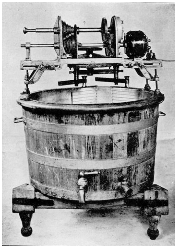
Electrische wrongelroerder. (De kap, welke de kamwielen beschermt, is voor het nemen van de foto weggenomen.)
