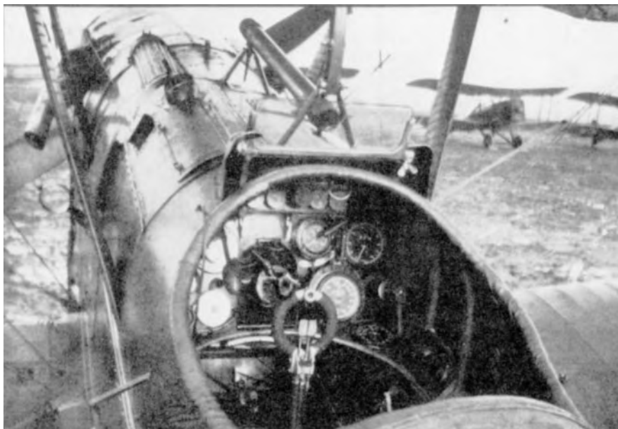
De cockpit van een SE-5A met het aangepaste kleine windscherm en de karakteristieke verrekijker, links daarvan de Vickers-mitrailleur.
