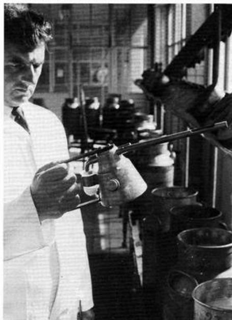
De alcoholproef. Zure melk gaat in combinatie met alcohol schiften. Door de melk met alcohol te mengen kon de fabriek nagaan of er zure melk werd aangeleverd.
