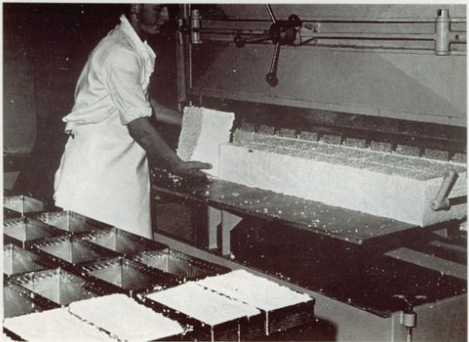
De overbrenging van de automatisch op lengte gesneden wrongelblokken in de kaasvaten
