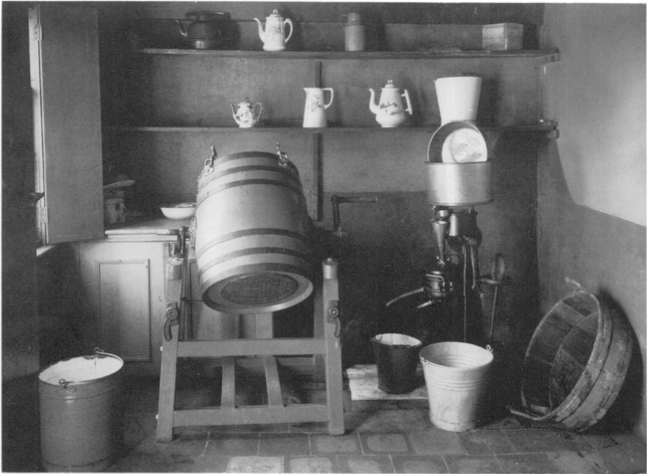
Boterbereiding op de boerderij in Zeeland rond de eeuwwisseling. De Zeeuwse boerin gebruikte daarbij de tuimelkarn, de handkrachtcentrifuge en de botertobbe waarin de boter met een houten pollepel wordt bewerkt. Geheel rechts staat nog een houten bakje voor het maken van z.g. natte schapenkaas (1)
