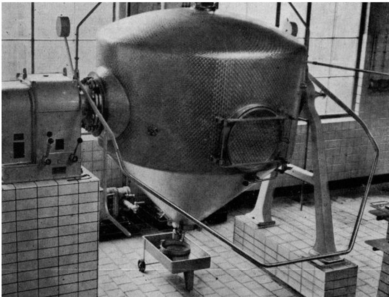
In deze moderne roestvrijstalen topkarn wordt uit 3000 L. room ca. 1200 kg. boter bereid
