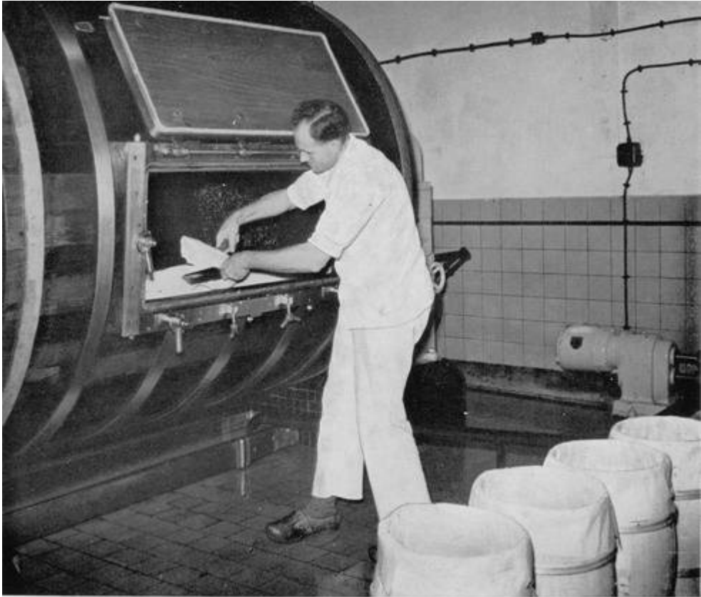
Deel van Botermakerij Karn met een nuttige ton-inhoud van 2000 L
