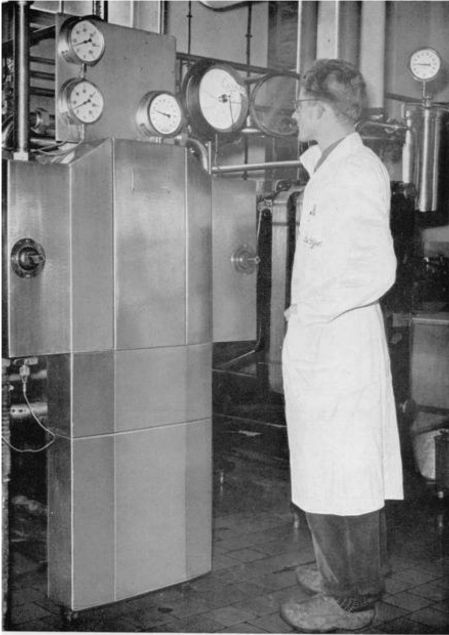
De veel kleinere en effectievere platenpasteur annex koeler met zelfregistrerende thermometer. Capaciteit 12.000 L. per uur
