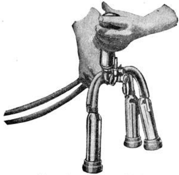
Het aanbrengen der tepelhouders.
