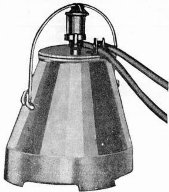
Emmer van de Simplex melkmachine. De vacuumslang ontbreekt.
