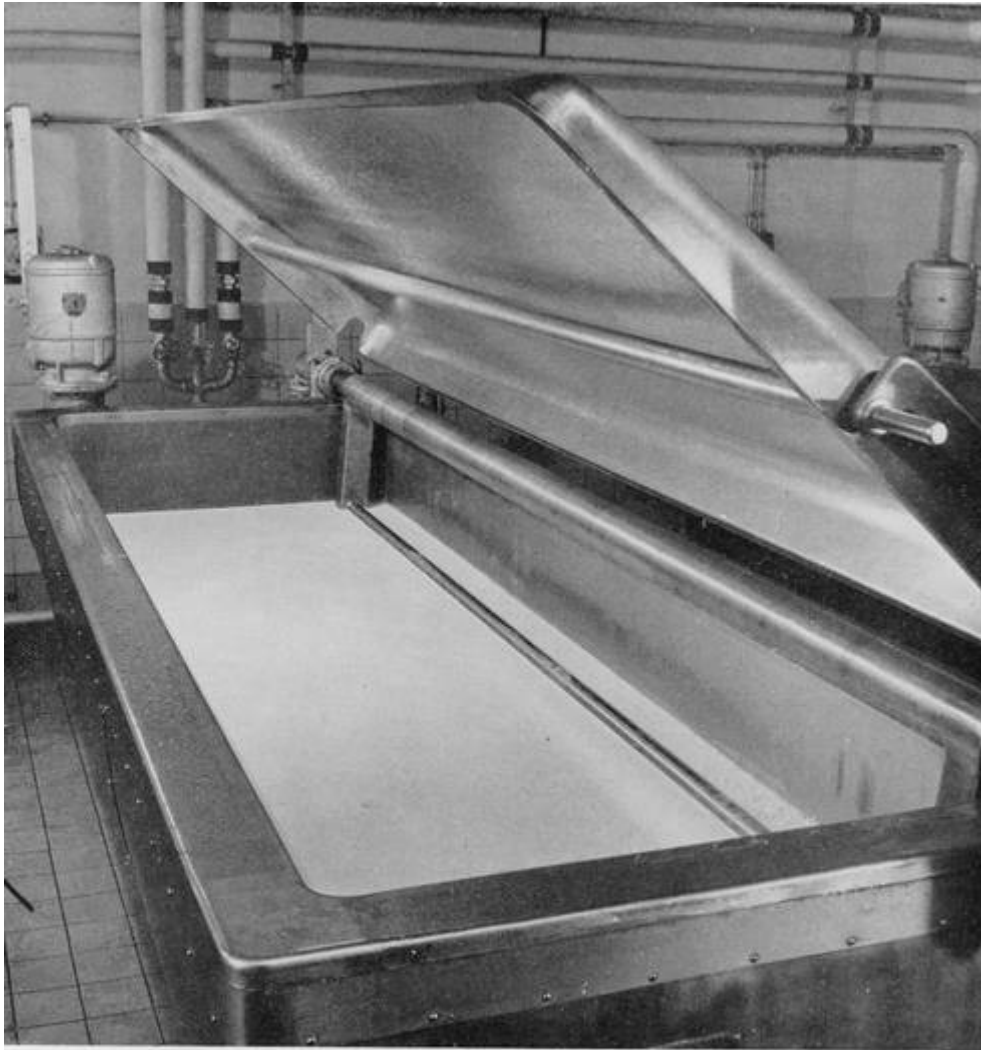
De melk is ontroomd en de room wordt te zuren gezet. De tank van roestvrij staal getuigt van de technische voortgang van de zuivelindustrie.
