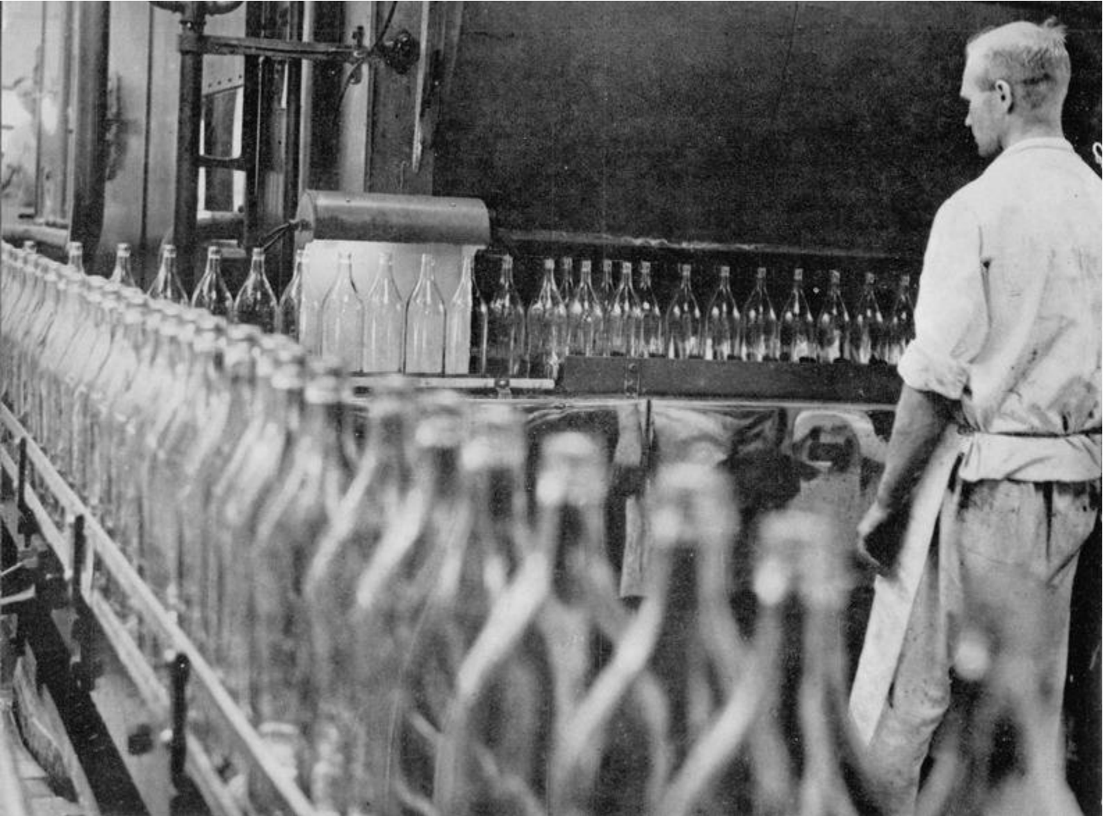
In een onafgebroken rij verlaten de schoongemaakte flessen de enorme reinigingsmachine
