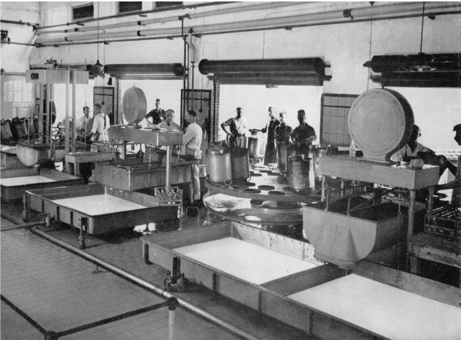
De „Melkontvangst”, Hier wordt de aangevoerde melk gewogen
