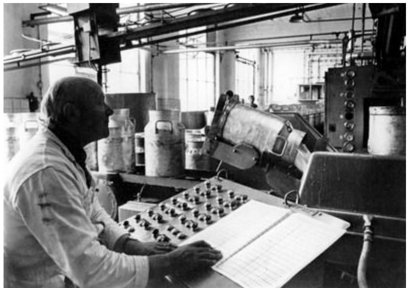
Fig. 46. Na de kannen- wasmachine (links) een rolbaan naar de snel- weger voer de afgifte van ondermelk (rechts).
