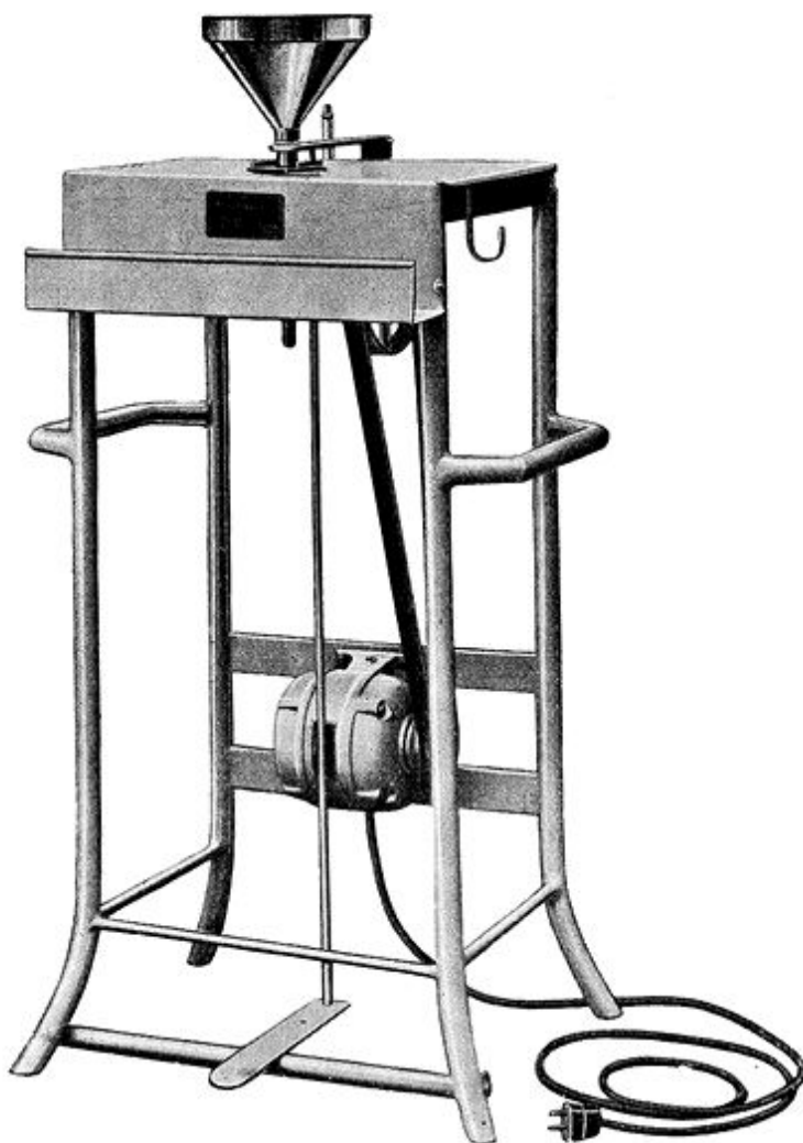
Fig. 38. Toestel van Van Doorn voor de bepaling van de zindelijkheidsgraad van melk. Een electromotor brengt een pompje in beweging, waarmee de melk door het wattenschijfje (Fig. 39) wordt gezogen.
