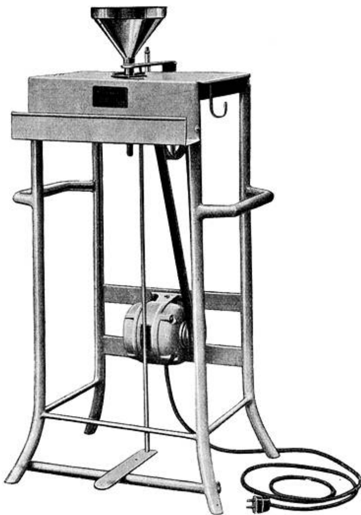
Fig. 38. Toestel van Van Doorn voor de bepaling van de zindelijkheidsgraad van melk. Een electromotor brengt een pompje in beweging, waarmede de melk door het wattenschijfje (Fig. 39) wordt gezogen.
