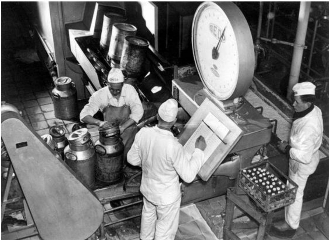
Fig. 42. Melkontvangst. met aanvoerbaan, stortgoot, melkbascule en automatisch monsterneem-apparaat.
